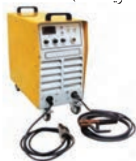
شکل ۱۳- ترانسفورماتور جوش برق
