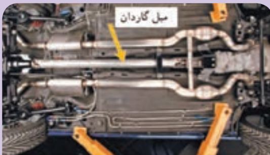
شکل ۳۲- میل گاردان بار گذاری پیچشی را برای انتقال گشتاور تحمل می کند.
